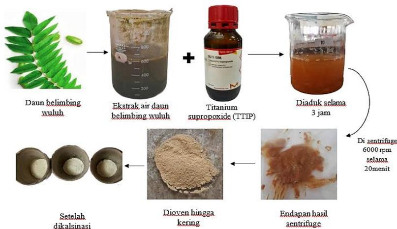
Gambar 1. Proses sintesis TiO<sub>2</sub>
