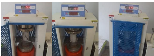
Gambar 5. Pengujian kuat tekan benda uji
