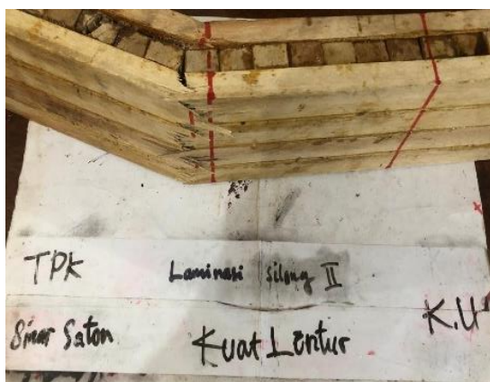
Gambar 8. Retak Pada Area Sambungan
