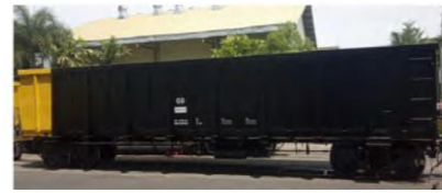
Gambar 7. Rollingstock Untuk Angkutan KA Batubara Sumber: PT INKA
