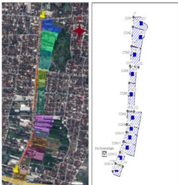
Gambar 2. Skema jaringan drainase eksisting
