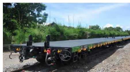
Gambar 6. Rollingstock Untuk Angkutan KA Semen
