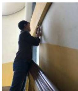
Gambar 21. Dokumentasi Hammer Tes pada Balok
