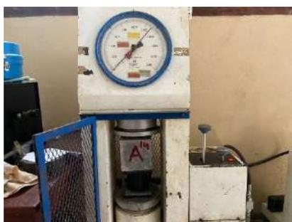
Gambar 2. Set up alat pengujian kuat tekan
