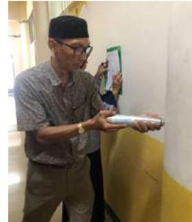
Gambar 22. Dokumentasi Hammer Tes pada Kolom
