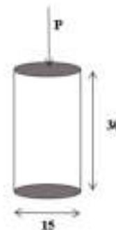
Gambar 1 Skema Pengujian Kuat Tekan Beton
