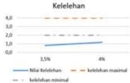
Gambar 7. Hasil dari Pengujian flow
