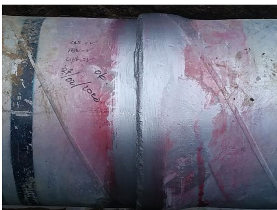
Gambar 2. Hasil pengelasan socket welded yang sudah di penetrant (sumber data internal OP BBWS Brantas)
