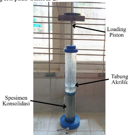
Gambar 2. Rakitan Tabung Konsolidasi dan Spesimen Konsolidasi
