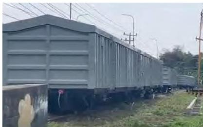
Gambar 5. *Rollingstock* Untuk Angkutan KA Pulp
