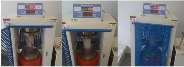
Gambar 5. Pengujian kuat tekan benda uji
