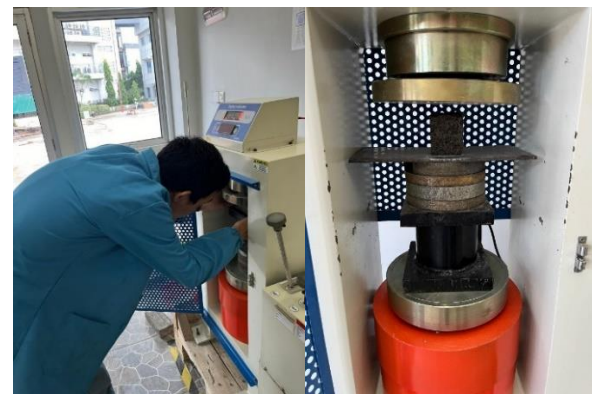
Gambar 6. Pengujian Kuat Tekan Paving Block
