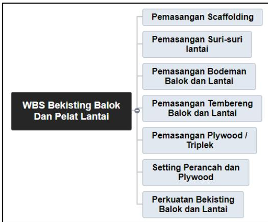
Gambar 2. *Work Breakdown Structure* Bekisting Balok dan Pelat Lantai.
