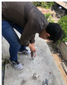
Gambar 20. Dokumentasi Hammer Tes pada Plat
