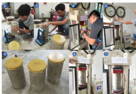
Gambar 8. Proses pengujian benda uji pada setiap variasi penggunaan superplasticizer Sika Viscocrete-3115N.
