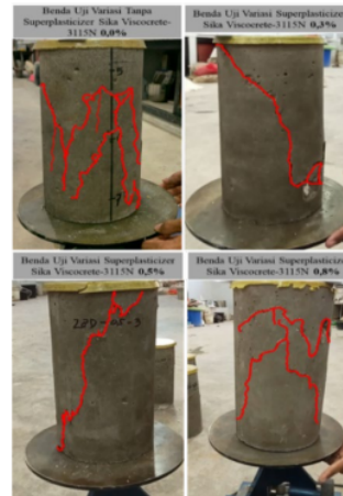
Gambar 15. Pola retak (pola kehancuran) benda uji pada usia pengamatan 28 hari.
