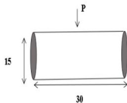
Gambar 2. Skema Pengujian Kuat Tarik Belah
