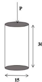
Gambar 1 Skema Pengujian Kuat Tekan Beton
