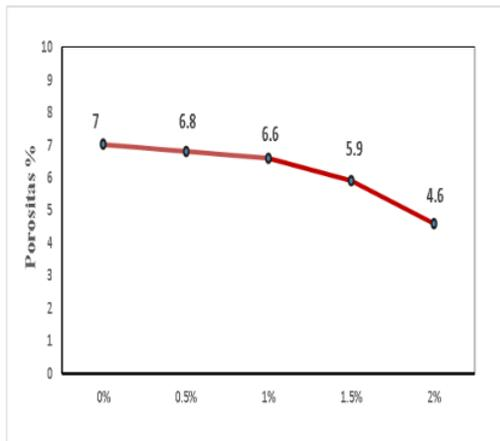
Gambar 7. Hubungan Porositas Dan Variasi Paku
