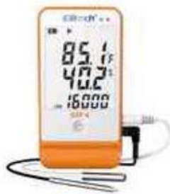
Gambar 7. Data Logger Elitech GSP-06. sumber : Dok. Penulis 2022
