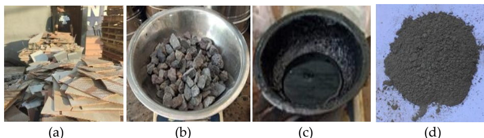
Gambar 1. (a) Limbah Keramik; (b) Agregat Alam Alam (c) Aspal ; dan (d) Filler Flyash (Dokumentasi Penulis, 2025)
