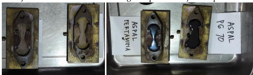
Gambar 1. Cetakan Benda Uji
