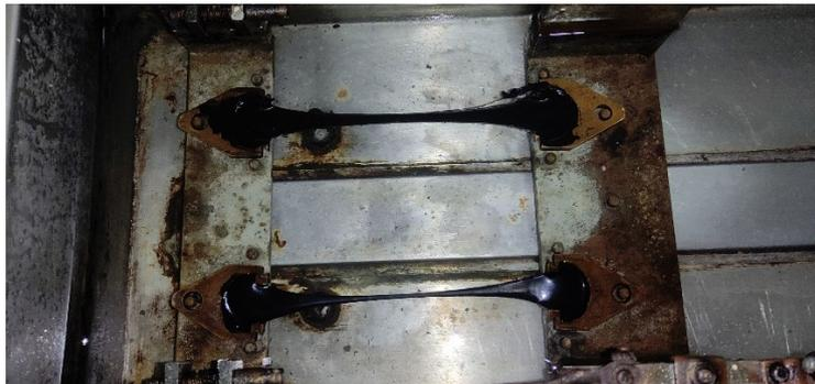
Gambar 3. Pemuluran Benda Uji
