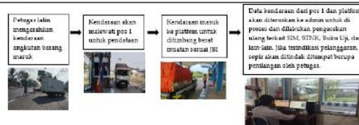
Gambar 7. Tahapan Penimbangan Jembatan Timbang Konvensional
