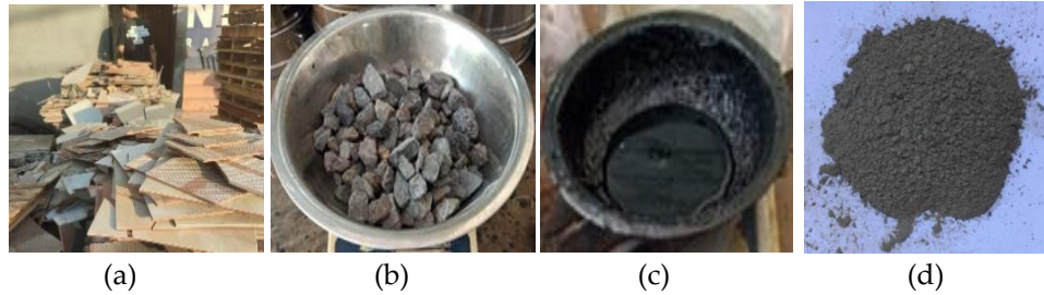
Gambar 1. (a) Limbah Keramik; (b) Agregat Alam (c) Aspal ; dan (d) Filler Flyash (Dokumentasi Penulis, 2025)
