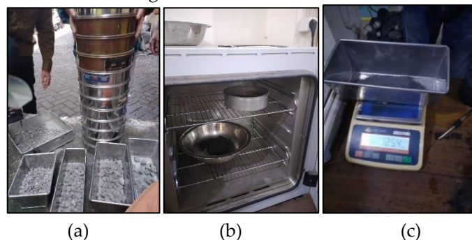
Gambar 1. Alat Penelitian: (a) Satu Set Saringan; (b) Oven; dan (c) Timbangan Digital (Dokumentasi Pribadi, 2024)
