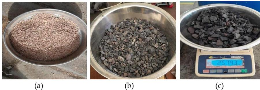
Gambar 2. Material: (a) Limbah Keramik; (b) Agregat Alam Halus; dan (c) Agregat Alam Kasar
