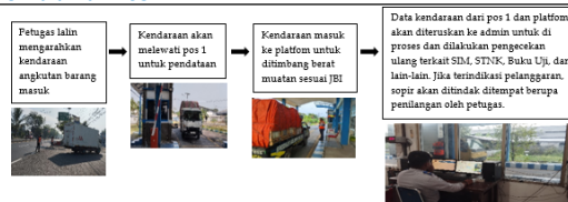
Gambar 7. Tahapan Penimbangan Jembatan Timbang Konvensional
