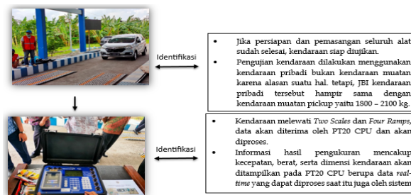
Gambar 6. Kendaraan melewati two scales dan four ramps serta gambaran informasi data masuk diproses oleh PT20 CPU
