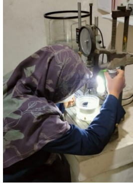
Gambar 7. Melihat Ujung Jarum Yang Sudah Bersentuhan Dengan Aspal
