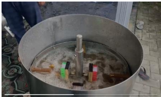
(d) mesin bekerja mencuci empon-empon dengan kecepatan putaran \pm 200 rpm
