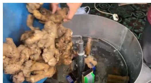
(b) empon-empon kotor \pm 5 kg dimasukkan ke wadah mesin yang sudah berisi \pm 8 L air
