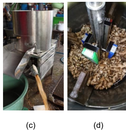
Gambar 7. (a) Bahan empon-empon sudah terendam dalam air di dalam mesin, (b) mesin siap difungsikan untuk mencuci empon-empon, (c) pengurusan/pembuangan air kotor setelah selesai proses pencucian, dan (d) penampakan empon-empon yang sudah bersih setelah sebelumnya dilakukan 2x pembilasan/penyemprotan
