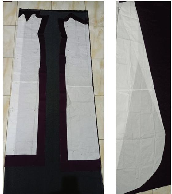
**Gambar 10. Peletakan Pola Pada Bahan Utama**
