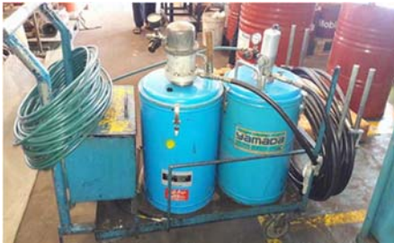
Gambar 9. Tempat Penyimpanan Yamada Pneumatic Grease Pump
