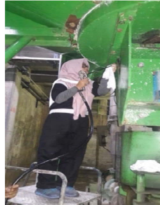
Gambar 6. Menutupi dengan Majun Saat Pengisian Grease
