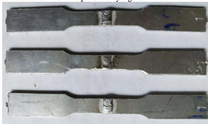
Gbr 1. Pembuatan spesimen uji Tarik
