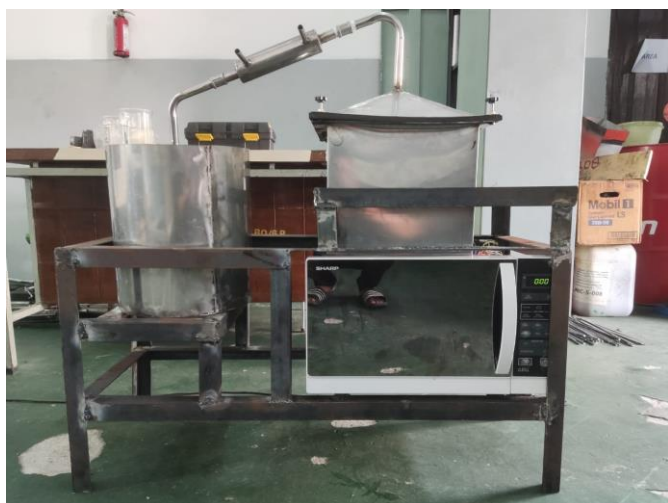
Gbr 4. Hasil Akhir Reaktor Destilasi Minyak Atsiri Dengan Metode MAHD
