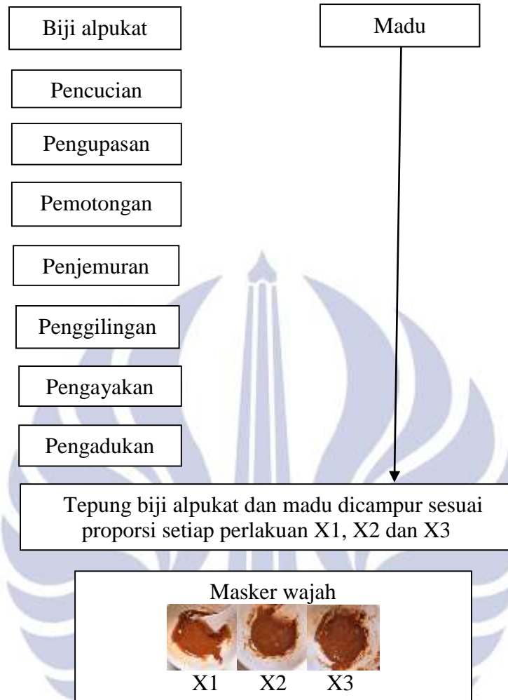
Gambar 1. Diagram Alir Pembuatan Masker Wajah
