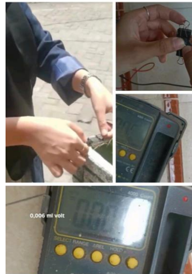
Gambar 7. Pengujian arus listrik menggunakan multimeter digital
