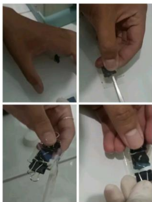
Gambar 6. Proses perakitan kaca ITO dan pemberian elektrolit KI
