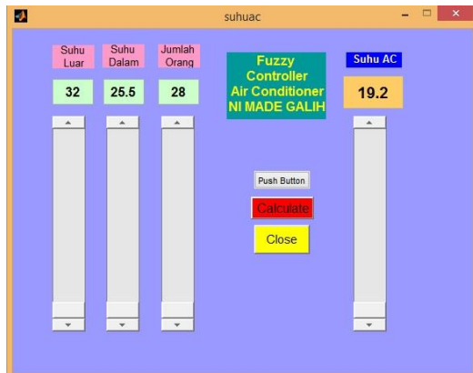
Gambar 3.7. Program Fuzzy Controller AC dan Hasil Final Output
