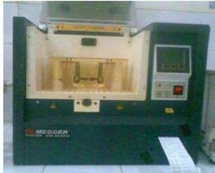
Gambar 3. Contoh Alat Uji Tegangan Tembus
