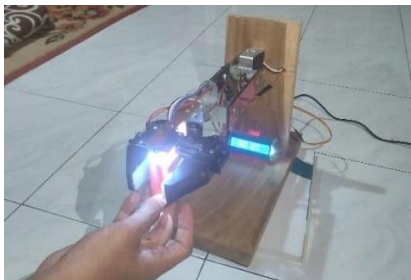
Gambar 16 Pengujian Kontrol Gripper Dengan Telegram
