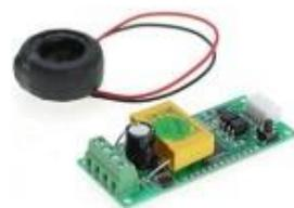
Gambar 4. Sensor Daya PZEM-004T
