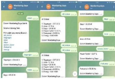
Gambar 7. Tampilan dari hasil pengukuran oleh sensor Pzem-004t pada Bot Telegram.
