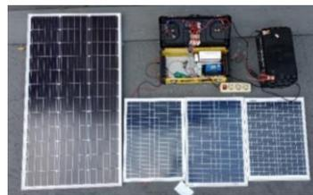
Gambar 5. Alat Monitoring Daya Listrik Panel Surya Berbasis *Internet of Thing* Menggunakan Aplikasi Telegram.
