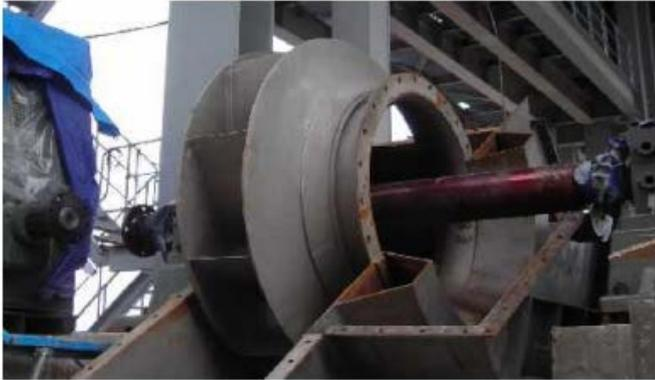
Gambar 3. Impeller primary air fan
