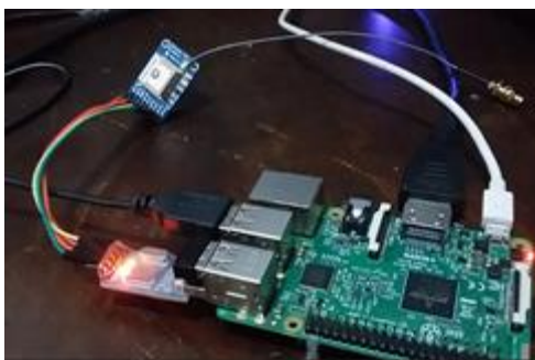
Gambar 7. Rangkaian pengujian sensor GPS.
