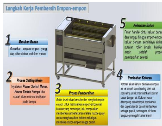
Gambar 4. Langkah kerja mesin pembersih serbaguna metode roller brush
