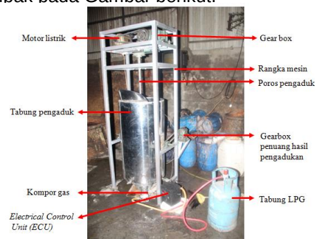
Gambar 1. Mesin pengaduk petis hasil proses manufaktur dan assembly
