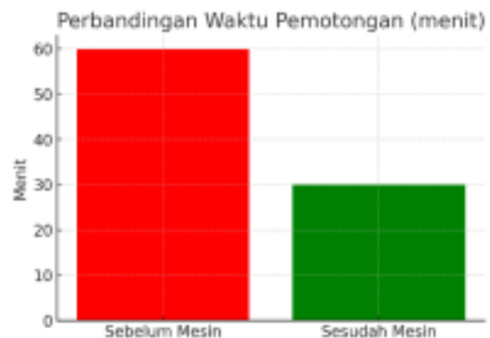
Gambar 2 Perbandingan waktu pemotongan adonan sebelum dan sesudah implementasi mesin pemotong
