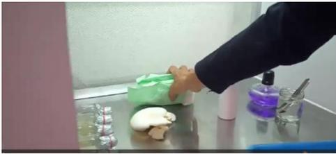
**Gambar 8.** Memasukan semua alat dan bahan yang sudah steril ke dalam alat LAFC yang sudah steril pula
