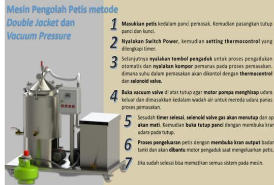
**Gambar 5.** Cara kerja mesin pengolah petis dengan teknik double jacket dan vacuum pressure
