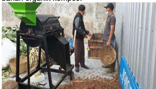
**Gambar 4.** Pengulangan Perajangan Bahan Menggunakan Alat Pencacah
