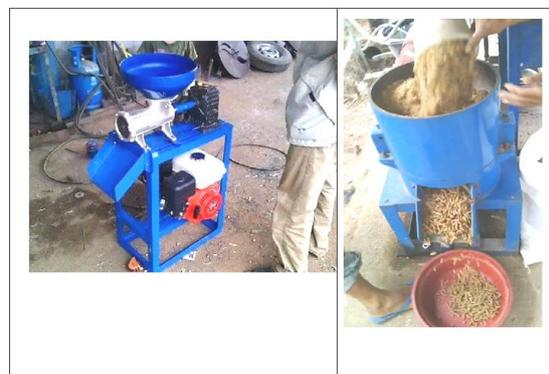
**Gambar 1.** Mesin pembuat pakan lele dalam bentuk pellet apung
