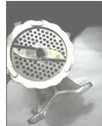
**Gambar 3.** Komponen pemotong (pisau) pada mesin pembuat pellet apung
