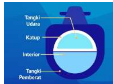
Gambar 14 Pengontrolan Daya Apung Kapal Selam (Sumber: marinebio.org diolah, 2024)
